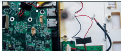
Přestože si velice vážíme všech, jejichž koničkem je domácí kutilství, nemůžeme jako reklamací uznat zákazníkem vytrhané konektory. Tento případ je jednou z nejčastějších NEUZNATELNÝCH reklamací.
